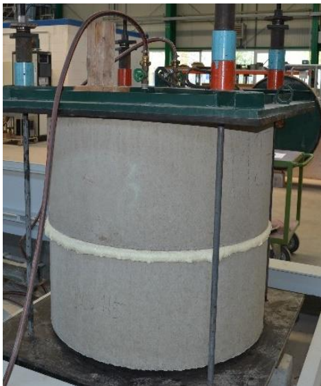
Abbildung 3: Ansicht der Verbindung der Schachtringe zum Ende der Prüfzeit
