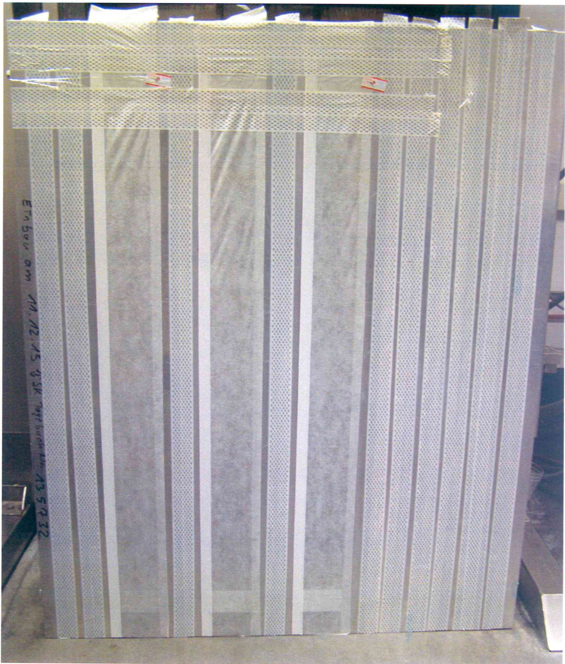
Bild 4: Versuchskörper, bestehend aus Hohlkammerprofilen (Querschnitt 60 mm x 100 mm) mit dazwischen befindlichen Fugen, über die die zu prüfenden Dichtungsfolien angebracht wurden (Fugenbreite 100 mm).
