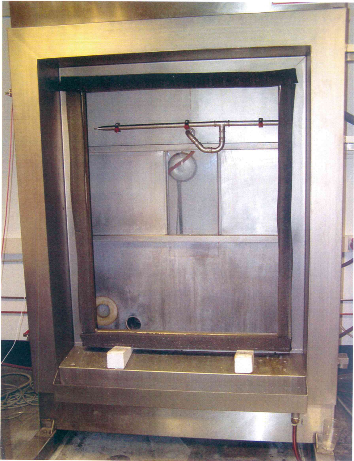
Bild 1: Offener Prüfstand ohne den eingesetzten Versuchskörper
